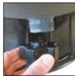
Tubo de desagüe con su tapón, de gran dimensión que sirve como herramienta de desmontaje
